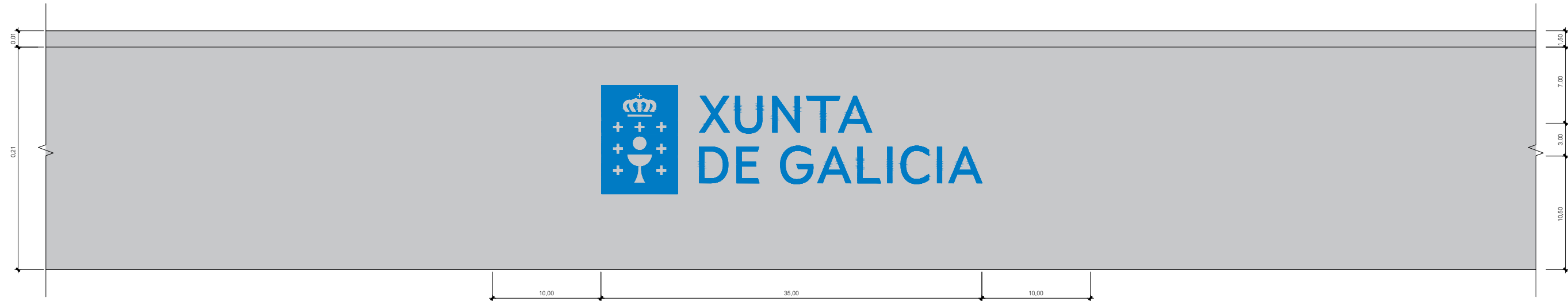
DETALLE DE BORDILLO CON LOGOTIPO DE XUNTA DE GALICIA ESCALA 1:10 (COTAS EN METROS)
